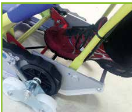
Støttefod aktiveres ved på- og afstigning. Rød = støttefod aktiveret, Blå = støttefod inaktiveret
